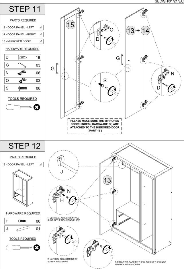
YOU SHOULD RE-ADJUST SCREWS AS SHOWN TO ALIGN DOOR ONCE HINGES HAVE BEEN ATTACHED.
