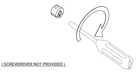
USE A FLAT HEAD SCREWDRIVER TO TIGHTEN THE CAM NUTS. A QUARTER TURN CLOCKWISE IS ALL THAT IS NEEDED.
