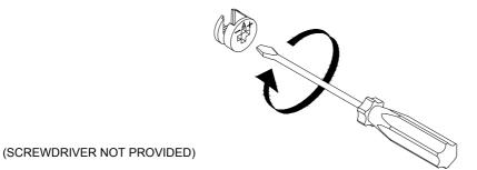
USE A FLAT HEAD SCREWDRIVER TO TIGHTEN THE CAM NUTS. A QUARTER TURN CLOCKWISE IS ALL THAT IS NEEDED.
