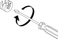
USE A FLAT HEAD SCREWDRIVER TO TIGHTEN THE CAM NUTS. A QUARTER TURN CLOCKWISE IS ALL THAT IS NEEDED.
